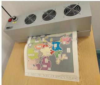
Ilustración 30: Producción de un dibujo termoinflado
