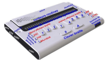
Ilustración 22: El ordenador Braille Eurobraille ESYTIME
